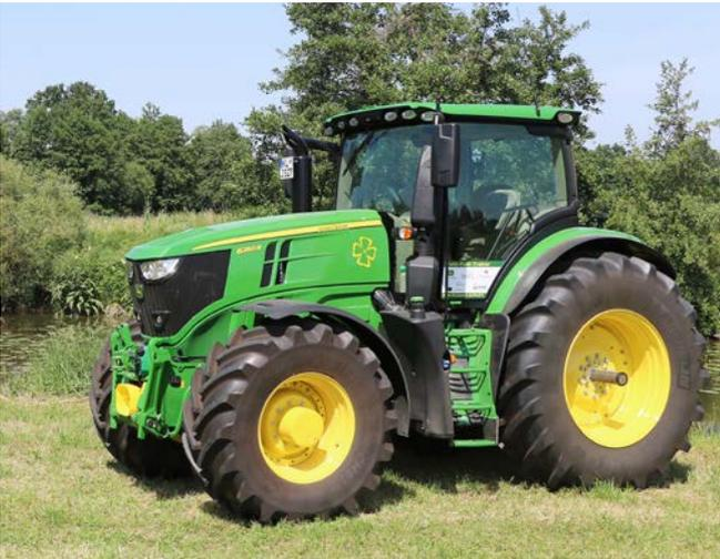
▭ Bild 2: TFZ Multi-Fuel-Forschungs-Traktor John Deere 6250 R der Abgasstufe 5 für Rapsölkraftstoff, Biodiesel und Dieselkraftstoff im Einsatz auf den Bayerischen Staatsgütern (Foto: TFZ)
