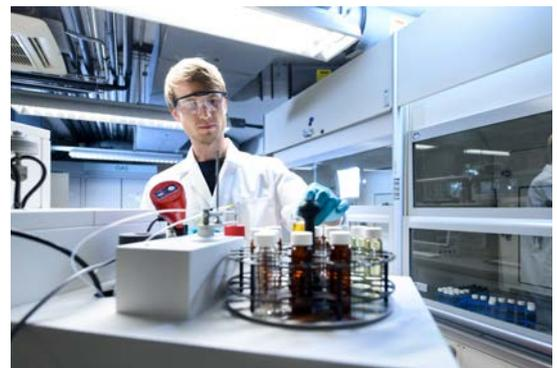
▣ Bild: Projektmitarbeiter Jürgen Gebhard vom TFZ untersucht mit dem AFIDA Prüfgerät das Einspritz- und Brennverhalten von Rapsölkraftstoff. Die Ergebnisse dienen der Motoroptimierung in Landmaschinen (Foto: Tobias Hase, StMELF)
