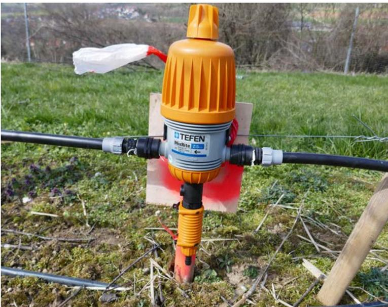
■ Bild 2: Technische Möglichkeit der zielgesteuerten Stickstoffausbringung
