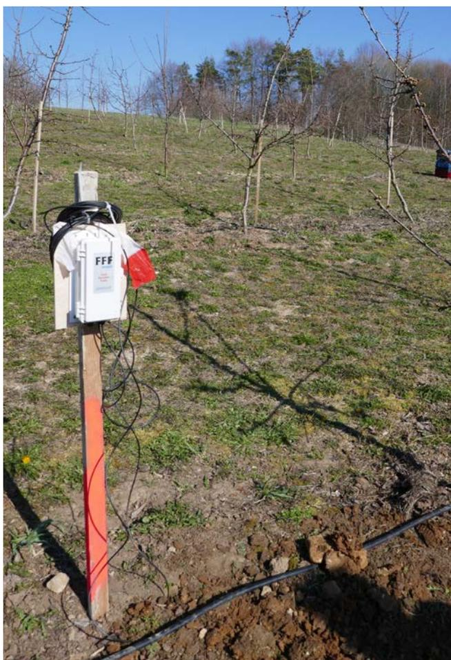
Bild 3: Bodenfeuchte-Überwachungsstation
