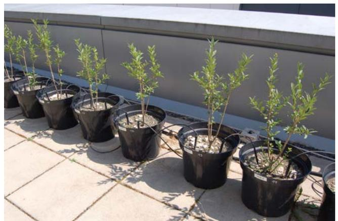
▣ Bild 2: In einem Topfversuch wird der Effekt von Pflanzenkohle auf die chemischen Eigenschaften von Baumsubstraten untersucht
