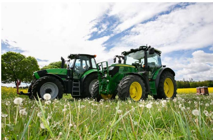
Bild 1: Rapsölbetriebene Schlepper (Foto: TFZ)
