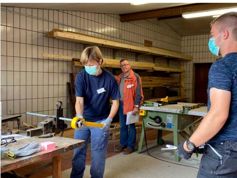
▭ Bild 4: Dr. Nadine Jäger, SG 60, schneidet unter Anleitung von Meisteranwärter Felix Pfülb ein Gewinde ins Wasserrohr
